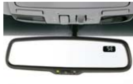
45 Selbstabblendender Innenspiegel mit Kompass H501SXA100 ★W Dunkelt bei Lichteinfall von hinten automatisch ab. Enthält einen elektronischen Kompass.
